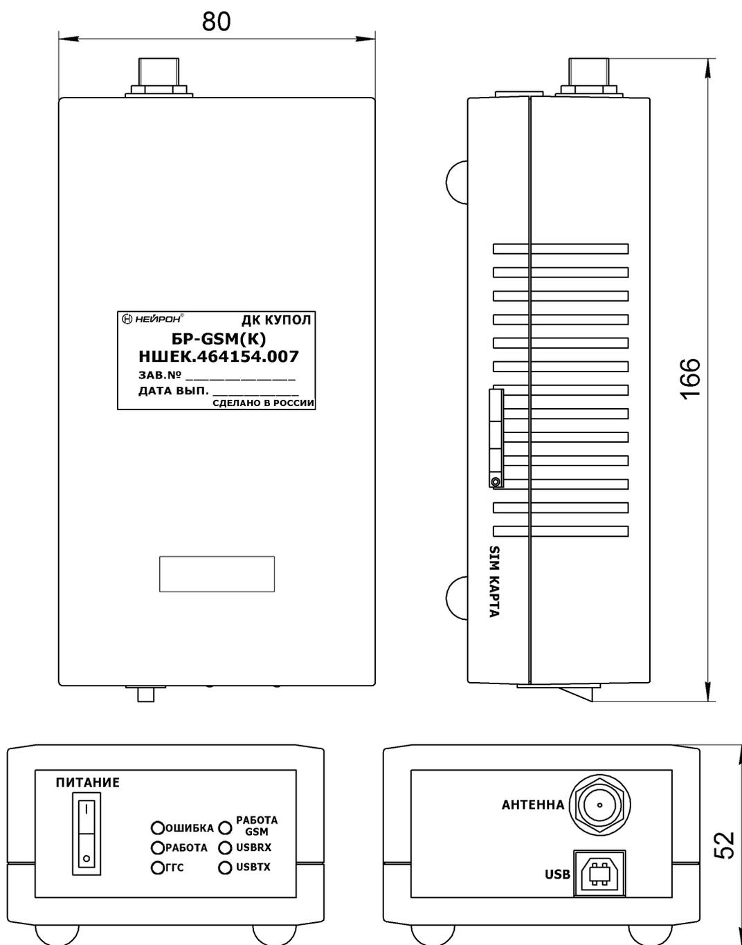
Рис.1 Внешний вид блока радиоканала БР-GSM(К) НШЕК.464154.007
